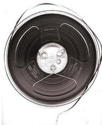
Слика 10.1: Магнетне траке коришћене током раног периода развоја електронских рачунара (слика преузета са Википедије)
